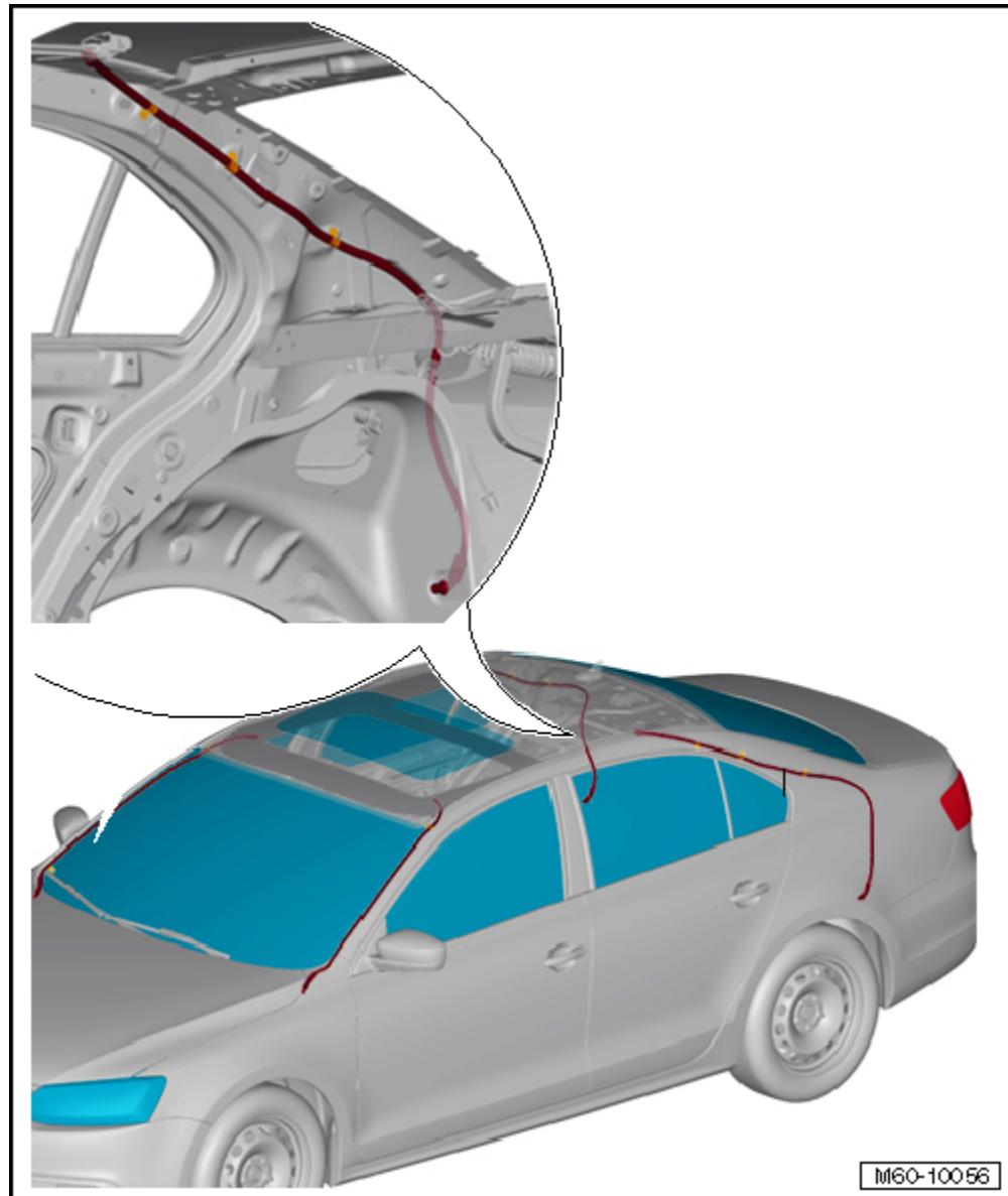
后排排水软管经过 C 柱，在后轮罩处结束。清洁从轮罩起进行，为此必须拆下轮罩内板 → **Kapitel**。
